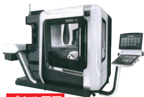
同時5軸加工のスタンダードマシン DMU50 3rd Generation
